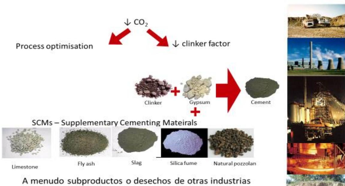
Figura 4. Enfoque actual de la reducción de la carga contaminante en la producción de CPO
