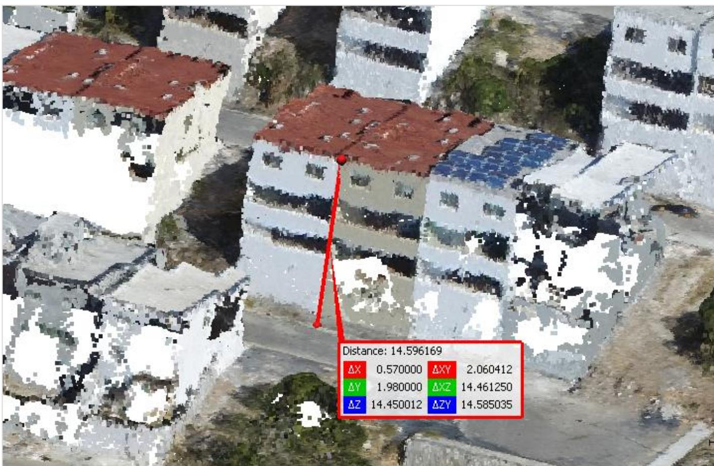
**Figura 3.** Medición de alturas a partir de nubes de puntos fotogramétricas obtenidas con dron.
