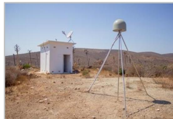
Figura 4. Proceso de construcción de monumento corto muy estable en estación sismológica de San Quintín, Baja California.
