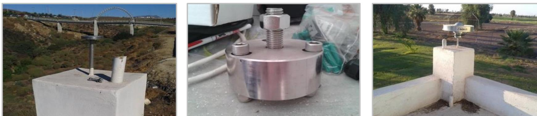
Figura 6. Base para antena geodésica utilizada en las estaciones del SSN.
