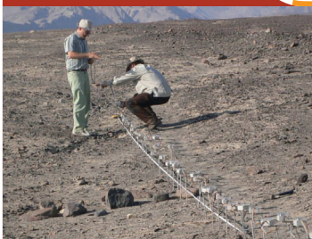
Mediciones Eléctricas a través de un Resistímetro de 4 puntos (Equipo de la Universidad de Clausthal-Zellerfeld).
